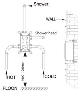
Выберите высоту для установки блока, глубина ниши для установки блока должна быть не меньше 53,5 мм. Лицевая часть блока должна быть установлена не глубже плоскости стены.
